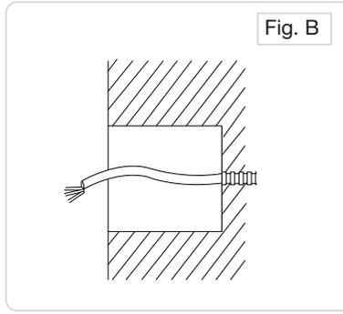
2. Poner el housing en la pared, el lado debe estar en el mismo nivel que el cable de la superficie para pasar por el housing.
