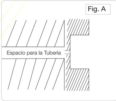
1. Es necesario que antes de instalar la luminaria y cualquiera de sus partes se tenga una preparación eléctrica y de obra civil como tubería de PVC o de algún material que permita la canalización del cable de alimentación hasta la lámpara.
