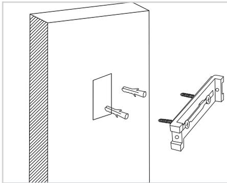
2.4 En la base fijadora colocar las dos pijas incluidas en el empaque y atornillar a los taquetes previamente fijados al muro.
