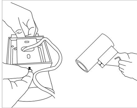
2.2 Retirar los tornillos que aprisionan la base fijadora a muro de la lámpara.
