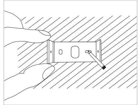
2.3 Marcar los orificios para taquete y pija en el muro donde se colocara la lámpara y con ayuda del taladro con roto martillo realizar los barrenos pertinentes para posteriormente introducir en ellos los taquetes ( incluidos en el empaque).
