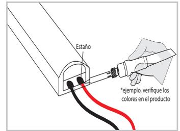
2.3. Usa el cautín para derretir la soldadura de estaño y fijar los cables (Verifica los polos positivo y negativo)
