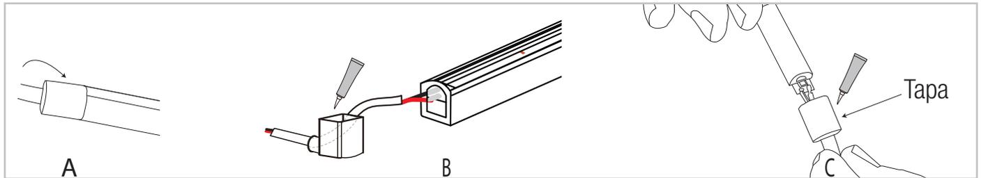
2.4 (A) Selecciona la tapa con orificio para la conexión con la fuente de alimentación, (B) Introduce por el orificio de la tapa , el cable y sella con pegamento.(C) Coloca con pegamento la tapa final al extremo contrario de la tapa inicial. *Deja secar al menos 24hrs para que sea efectivo.*
