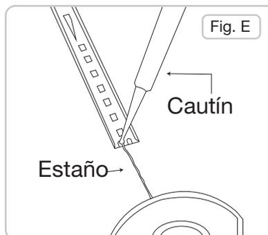
**2.** Estaña los cables de la tira y de la fuente de poder con soldadura y coloca las fundas termo contráctiles para evitar cortos circuitos.
