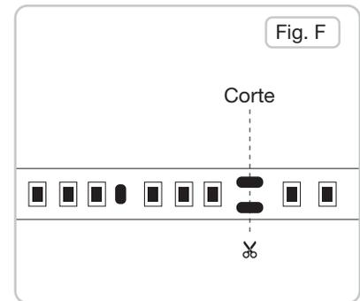
**3.** Para realizar un corte se tendrá que visualizar las líneas de corte sobre el PCB y cortar justo sobre la línea marcada para no dañar los PAD's de soldadura y no dañar el circuito serie - paralelo de la tira. Este corte se tendrá que hacer con tijeras finas.
