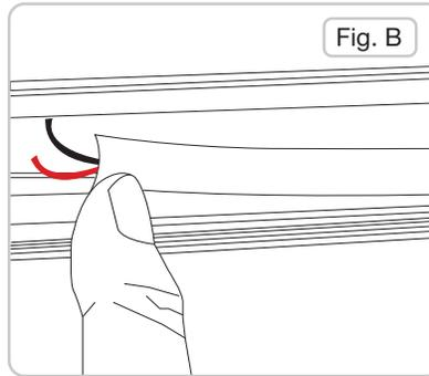
**2.** Coloca la punta de la tira luminosa en la punta de la canaleta, con el dedo pulgar haz presión por todo el cuerpo de la tira desplazando longitudinalmente por toda la canaleta, esto para adherir la cinta doble cara de la tira a la canaleta.
