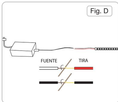
**1.** Es necesario hacer las preparaciones eléctricas de modo que el cable de alimentación DC de la tira se pueda unir con el cable de alimentación DC que viene desde el driver
