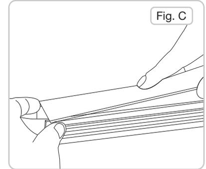
**3.** Coloca el difusor de la canaleta sobre el perfil, desplázalo cuidadosamente de forma que embone sobre el perfil de aluminio.
