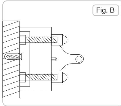
**2.** La luminaria cuenta con una base que permite la fijación a cualquier superficie plana. Está deberá desatornillarse de la lámpara para poderse fijar mediante taquetes y tornillos para después de estar fija poder atornillar la lámpara.
