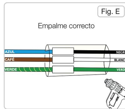
**5.** El empalme de la extensión deberá ser aislado con fundas termo contráctiles en la unión de los pines y con una funda termo contráctil con resina para resguardar el empalme en general contra la humedad.
