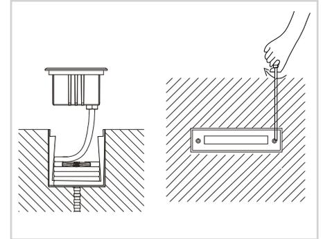
2.2 Pon la luminaria dentro del housing y fije la luminaria atornillando sobre los dos lados de la cubierta.
