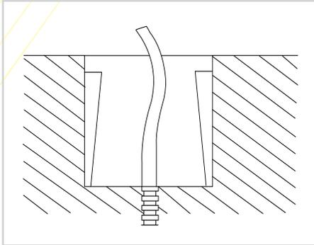
2. Instalar el housing en el suelo, el lado superior debe estar en el mismo nivel que la superficie del suelo, el cable necesita pasar por el housing.
