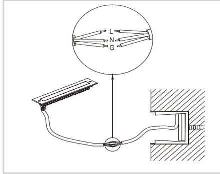
Conecta el cable con la luminaria. \*Mantener la suficiente longitud para realizar el mantenimiento. Utiliza conectores intermedios para conexiones continuas, evitará filtraciones en los enlaces.
