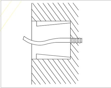
Instalar el housing en el suelo, el lado superior debe estar en el mismo nivel que la superficie del suelo, el cable necesita pasar por el housing.
