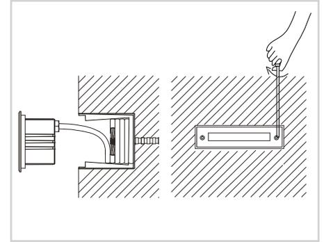
Pon la luminaria dentro del housing y fije la luminaria atornillando sobre los dos lados de la cubierta.
