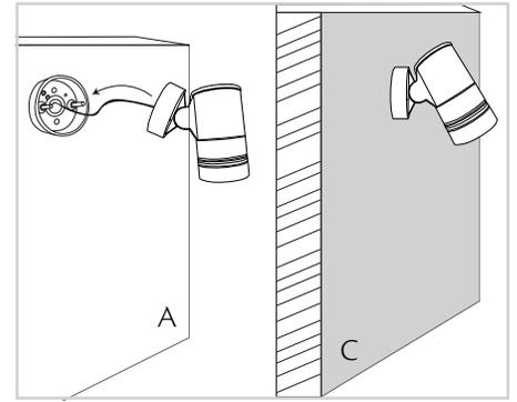
2.6 Empata la tapa de fijación con la base de la lámpara, acomoda los tornillos y usa las rondanas plásticas y las tuercas hexagonales ciegas para inmovilizar el equipo.
