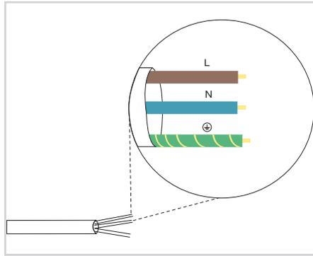
2.5 Se puede identificar la polaridad el cable por el color del mismo o con las etiquetas de los cables.
