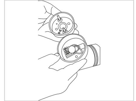
2.3 Retira la tapa que servirá para marcar los orificios donde se va a perforar.
