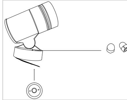
2.2. En la base de la lámpara hay una tapa de fijación, para poder instalar es necesario retirar la goma con adhesivo y los tornillos (tuercas hexagonales "ciegas") que aprisionan la base fijadora.
