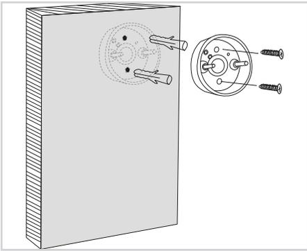
2.4 Una vez marcados los puntos donde se va a perforar, coloca los taquetes de plástico y el par de pijas para fijar. Selecciona la broca adecuada (Depende de la zona a instalar) y realiza la perforación.
