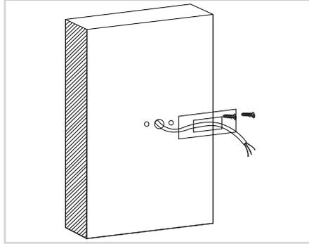
2.2 Fije la cubierta posterior del soporte en la pared con dos tornillos de acero. Asegúrate de que el cable atraviese el agujero en el medio.
