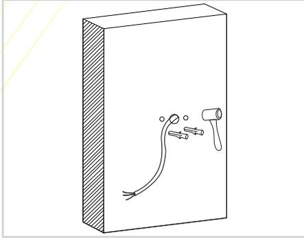
2.1 Haga dos agujeros en la pared donde va a instalar la luminaria. Poner dos tapones de goma en los orificios, respectivamente, usando un martillo.
