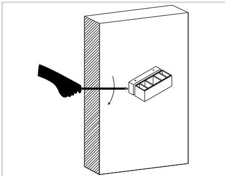
2.4 Fije el accesorio en la cubierta posterior del soporte con cuatro tornillos.
