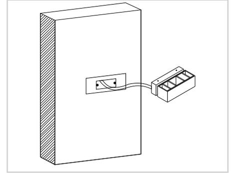
2.3 Conecte la luminaria con el cable que ha sido preparado para la instalación previamente.
