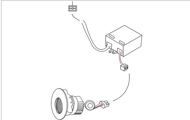
2.3 Conectar el conector macho con el conector hembra de la lámpara y Retroceder las anclas de la lámpara hacia atrás para que estas pasen por el agujero que se hizo anteriormente, esto con ayuda de nuestros dedos índice y pulgar, Asegurar que todo el cable quede dentro del hueco correspondiente e ingresar las anclas de la lámpara al interior una vez que estén dentro las anclas solo se tendrán que soltar y estas colocaran la lámpara por si solas en la posición indicada.
