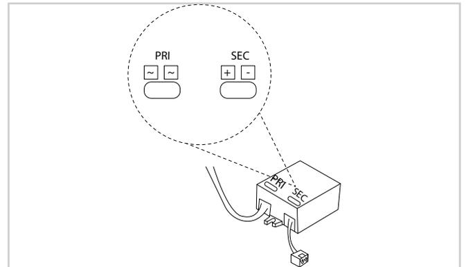
2.2 Sacar por el hueco que se acaba de hacer los cables de alimentación mencionados anteriormente de 100~240V y conectar en los bornes especificados en la fuente (PRI) una vez conectados estos, conectar el cable conector macho (negro y rojo) en los bornes indicados en nuestra fuente (SEC) respetando la polaridad marca en el chasis de la fuente.
