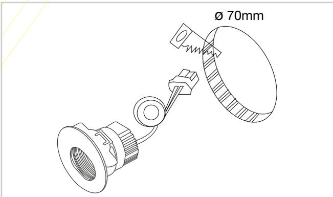
2.1 Para montar en plafón será necesario utilizar un taladro con broca sacabocados (imagen) preferentemente que ronde entre los 39mm y 40mm de diámetro, y realizar la perforación de plafón con dicha broca en el lugar deseado. Cabe mencionar que antes de cerrar el plafón de tabla roca se debió haber dejado la preparación eléctrica de 100~240VAC para poder conectar a la fuente de alimentación de nuestra lámpara.
