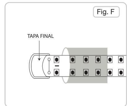
**6.** Colocar funda termocontráctil del otro extremo de la manguera y poner la tapa final.
