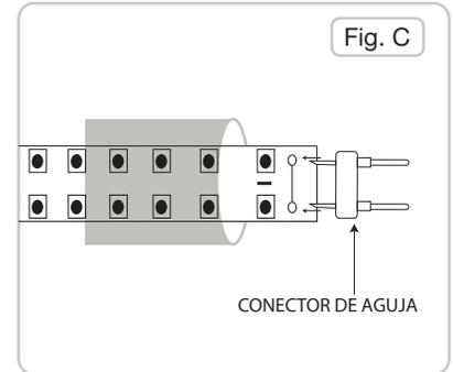
**3.** Introducir el conector de aguja por los orificios del extremo de la manguera y asegurarse de que el conector entre por completo.
