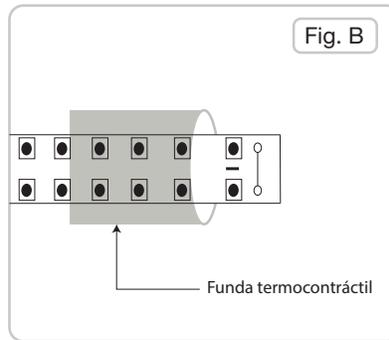
**2.** Colocar un pedazo de funda termocontráctil a través de la manguera.
