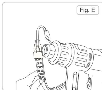
**5.** Una vez conectado, con una pistola de calor se expande la funda para que se contraiga y cubra todo el empalme y así quedará sellada para que no se filtre el agua.
