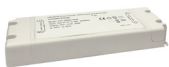
XD2460.1 Fuente de alimentación dimmeable entrada 100~277VAC, 0.76A, 50/60Hz, salida 24V, 2.5A, Máx 60W, IP20
