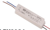
LPV6024 Fuente de alimentación 60W, Vin: 100~240 VAC 50-60Hz, Vout: 24VDC, 2.5A, Temp. de Op.: -30 ~70°C, Dimensiones: 162.5*42.5*32mm, IP67
