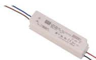
LPV6024 Fuente de alimentación 60W, Vin: 100~240 VAC 50-60Hz, Vout: 24VDC, 2.5A, Temp. de Op.: -30 ~70°C, Dimensiones: 162.5*42.5*32mm, IP67
