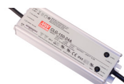
LM15024 Fuente de alimentación 150W, Vin: 100~277 VAC 50-60Hz, Vout: 24VDC, 6.3A, Temp. de Op.: -40 ~90°C, Dimensiones: 228*68*38.8mm, IP67
